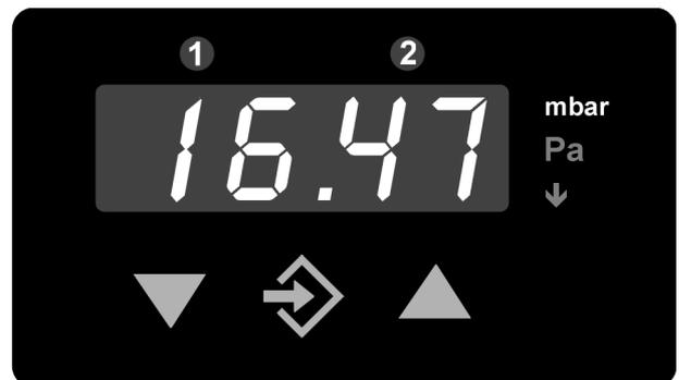
Die 3½ stellige LED-Anzeige stellt im Normalbetrieb den aktuellen Differenzdruck dar. Rechts von der Anzeige wird die gewählte Messeinheit hinterleuchtet. (Hinweis: Die auf dem Bild dargestellten Einheiten können von der tatsächlichen Ausführung abweichen.) Oberhalb der Anzeige symbolisieren die zwei Leuchtdioden 1 2 den Zustand der Schaltausgänge (LED leuchtet = Schalter ist geschlossen).
