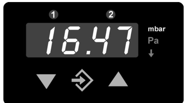
Die 3½ stellige LED-Anzeige stellt im Normalbetrieb den aktuellen Differenzdruck dar. Rechts von der Anzeige wird die gewählte Messeinheit hinterleuchtet. (Hinweis: Die auf dem Bild dargestellten Einheiten können von der tatsächlichen Ausführung abweichen.) Oberhalb der Anzeige symbolisieren die zwei Leuchtdioden ① ② den Zustand der Schaltausgänge (LED leuchtet = Schalter ist geschlossen).
