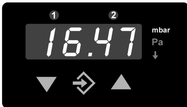
Die 3½ stellige LED-Anzeige stellt im Normalbetrieb den aktuellen Differenzdruck dar. Rechts von der Anzeige wird die gewählte Messeinheit hinterleuchtet. (Hinweis: Die auf dem Bild dargestellten Einheiten können von der
