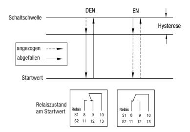
Die Hysterese ist zu jedem Schaltpunkt frei programmierbar. In der Funktion DEN zieht das jeweilige Relais mit erreichen der Schaltschwelle an, in der Funktion EN fällt das jeweilige Relais mit erreichen der Schaltschwelle ab. Durch Verwendung der Funktion EN kann z.B. ein Ausfall der Versorgungsspannung als Alarm signalisiert werden.
