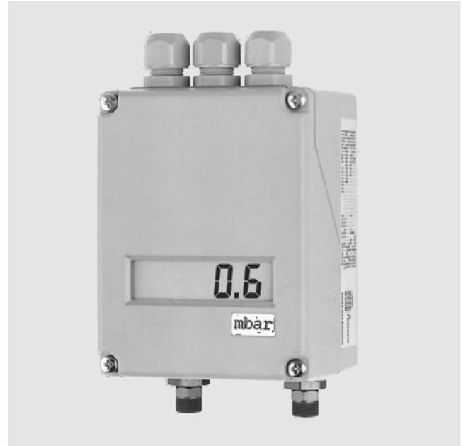
Mittels eingebautem LC-Display (optional) ist eine lineare Messwertdarstellung der Druck-/Differenzdruckwerte vor Ort möglich.
